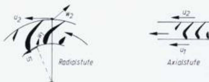
Bild 2.1.3 Umfangsgeschwindigkeit bei Radial- und Axialstufen
