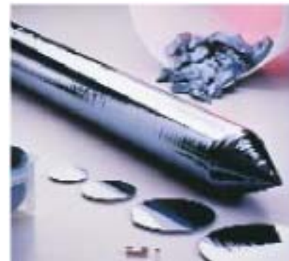
Siliziumstab für die Chip-Produktion
