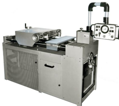
Foto 4: Abroll – Prägeautomat für Zylinderstifte und Bolzen AZB (s. Pos. 10)
