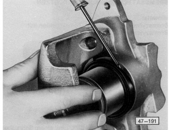
Abb. 4 Innere Dichtlippe der Schutzkappe mit einem Schraubenzieher in die Nut des Zylinders einsetzen
