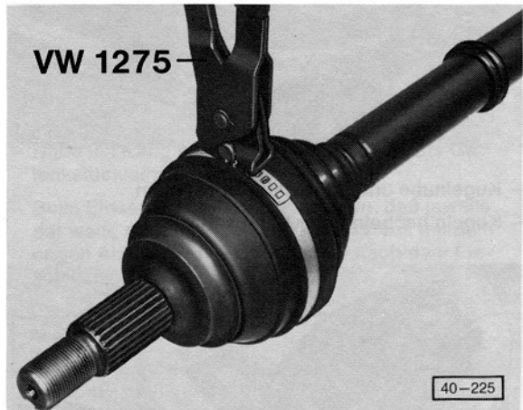
Abb. 5 Schlauchbinder spannen
