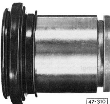
Abb. 3 Schutzkappe mit der äußeren Dichtlippe auf den Kolben setzen
