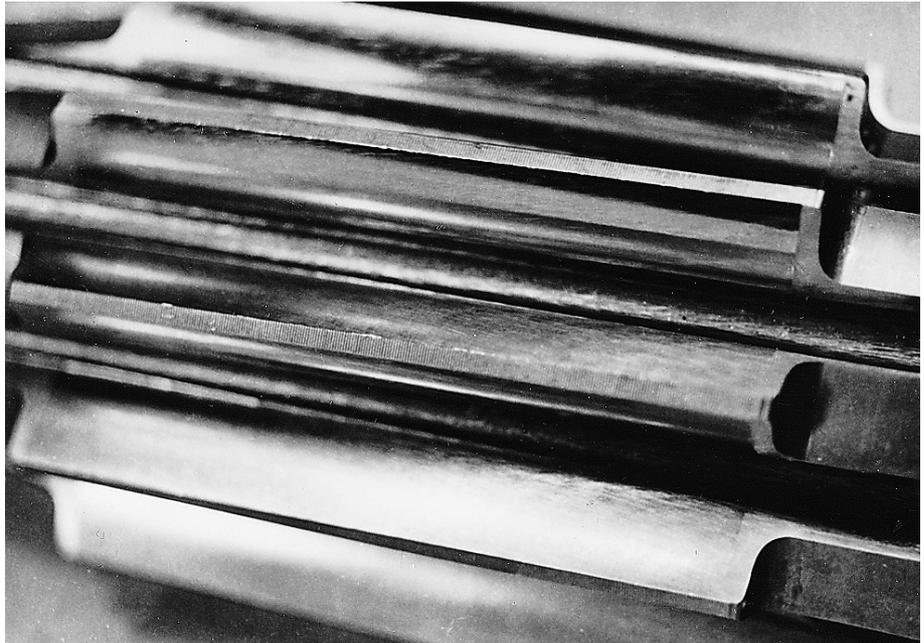
Bild 17.8 Zahnflanken in ausgezeichnetem Zustand nach einem Dauerversuch über 24 000 Betriebsstunden zur Prüfung der Alterungsbeständigkeit von Schmierstoffen
