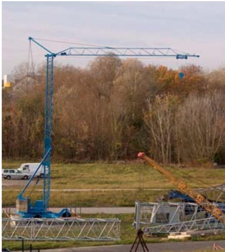
Dieser Kran ist der "Ur-Vater" des Schnellaufbaukrans mit Klappturm".
