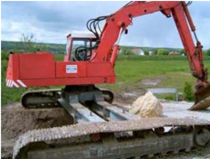
Bei Schwing (heute Schwing-Stetter Betonpumpen) wurden von 1959 bis 1990 Spezialbagger zum Planieren und Profilaushub hergestellt.
