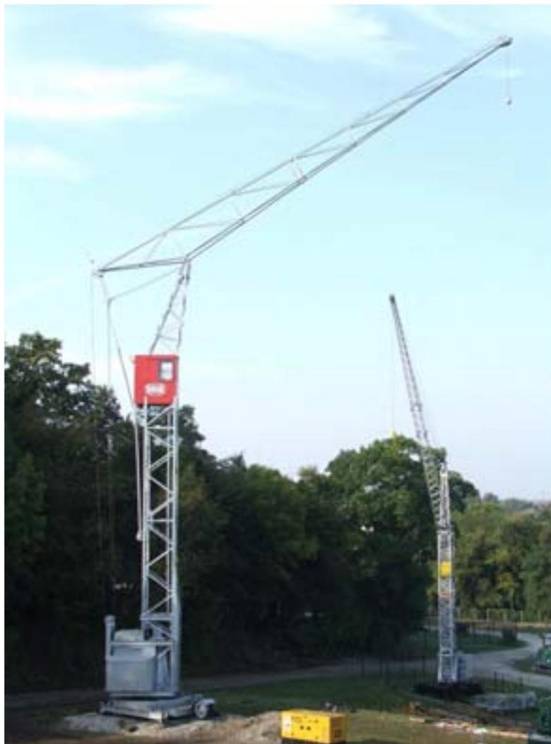
Diese Krankonstruktion des Schweizer Unternehmens Brun & Cie. stammt aus dem Jahr 1950/51 und wurde bis etwa 1960 gebaut. In seiner Konstruktionsart handelt es sich um einen für diese Zeit typischen Turmdrehkran mit Biegebalkenausleger. Die Besonderheiten dieses Krans waren der dreieckige Auslegerquerschnitt, Auslegerverstellung über einen Kettentrieb und vor allem ein horizontaler Lastweg, der mittels einer entsprechend durchdachten Seilführung erreicht wird.
