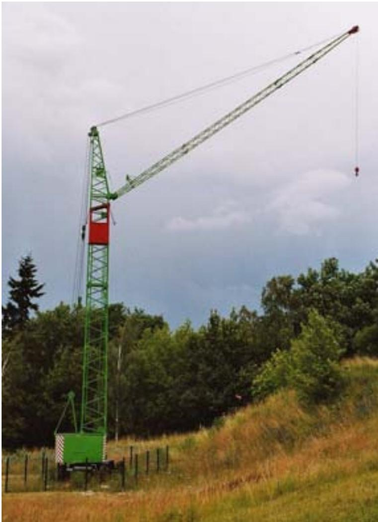
Der Reich F 10 (N10/12) war ein sehr kompakter und robuster Kleinkran, der sich in ab Ende der 1950er Jahre bis weit in die 1970er Jahre großer Beliebtheit erfreute. Er verfügt über einen Unterwagen in Kastenbauweise, Kugeldrehkranz, Oberwagen mit Hub-, Verstell- und Drehwerk, abnehmbaren Seitenballastkästen und Schaltschrank, starrem und teilbaren Kranturm, teilbarem Ausleger. Einsetzbar ist er sowohl stationär als auch schienenfahrbar.
