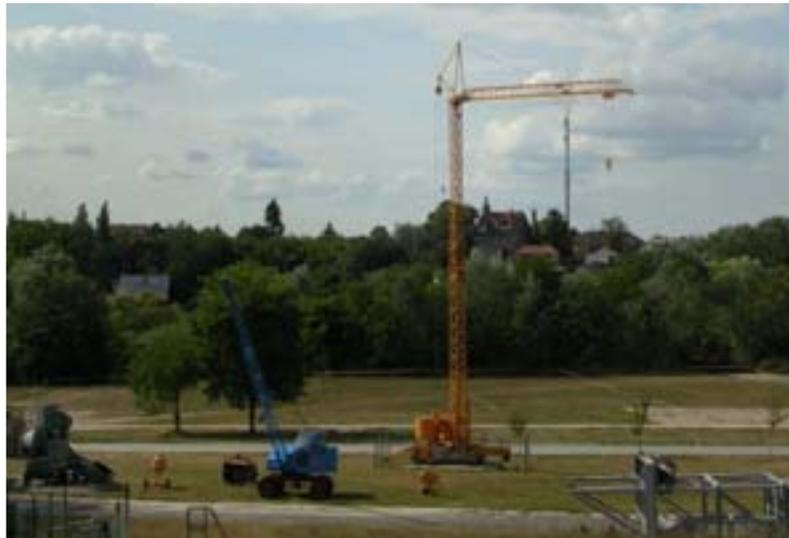
Der Liebherr Form 10 K wurde in der ersten Hälfte der 60 er Jahre des letzten Jahrhunderts für den Einsatz an kleineren Bauprojekten entwickelt. Er bietet die Möglichkeit für den stationären oder schienenfahrbaren Einsatz. Für den Straßentransport wurde ein luftbereiftes Fahrwerk montiert. Die Drehsäule des Kranes ist teleskopisch aus- und einfahrbar.
