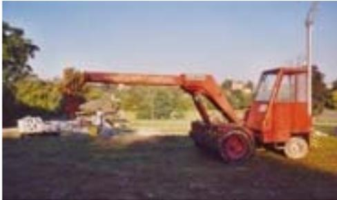
Neben Baggern und Fahrzeugkränen produzierte die Deutsche Maschinenbau AG (DEMAG) auch kleine, recht kompakte Mobilkrane für den Lastentransport in Industrieunternehmen. Der Demag V 35 ist ein typischer, noch früher Vertreter dieser Produktgruppe.
