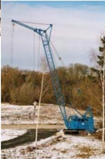
Schwerer Raupenkran aus „DDR“-Fertigung. Geräte dieser Kategorie werden zum Teil heute noch als Montagekrane sowohl im Hoch-, Stahl- und Tiefbau, im Betonfertigteilebau und auf Lagerplätzen eingesetzt.
