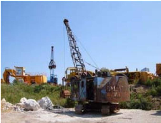
Gebaut in den 1930er Jahren war der Bagger mit Gittermast, Hochloeffel, Tiefloeffel, Planierausleger, Stampfer und Ramme erhältlich. Ein echter Universalbagger. Das „E“ steht für Einmotorenbagger, die grösseren Geräte wurden meist mit mehreren Motoren für verschiedene Bewegungen geliefert. Demag setzte schon früh das Elektroschweisverfahren statt der damals üblichen Nietkonstruktionen ein. Dadurch konnten die Bauteile schlanker und ökonomischer gebaut werden.
