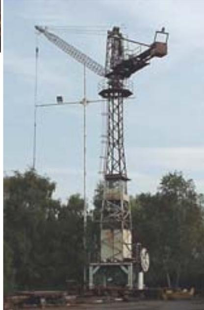
Diese Krankonstruktion ist der „Urvater“ aller Obendreherkrane!
