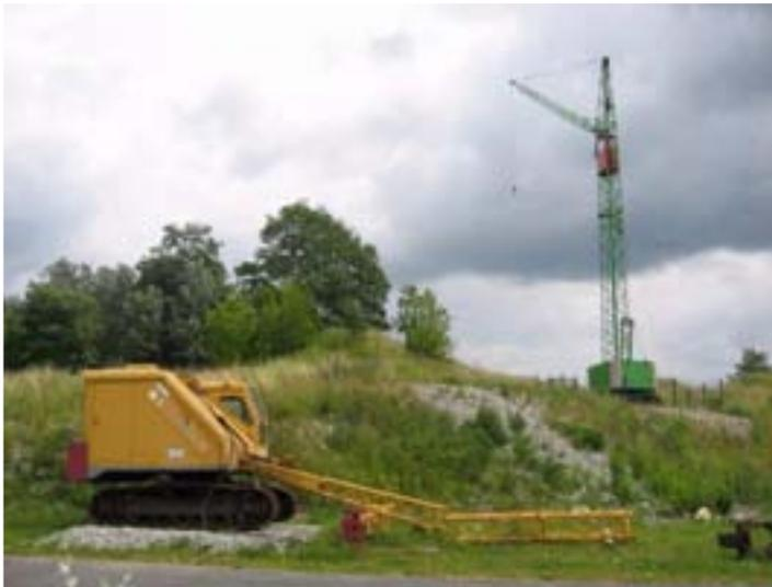
Als kleinsten Seilbagger der neueren Typenreihe konstruierte Weserhütte den W 40, der nur wenig mehr als 11 Tonnen auf die Waage brachte.
