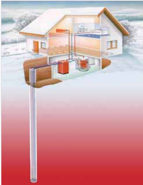
Bild 2: Sondenbohrung für flache Geothermie
