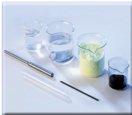
Abbildung 3: Die Zutaten sind: reines Paraffinöl, ein Stück reines Natrium, reiner Schwefel, Graphitpulver (in den Bechergläsern von links nach rechts). Zum Abgreifen des Potentials an der Kathode (positiver Pol) dient ein sauberer Graphitstab. Für die Anode (negativer Pol) braucht man zudem einen entfetteten, rostfreien Eisenstab sowie ein kleines Reagenzglas. Es sollte aus Borosilikatglas (beispielsweise Jenaer Glas) bestehen; Quarzglas darf auf keinen Fall verwendet werden. Zur Sicherheit sollte zudem ein Metallbrand-Feuerlöscher in Griffweite stehen (alle Labor-Abbildungen: Udo Geisler / photon-pictures.com).
