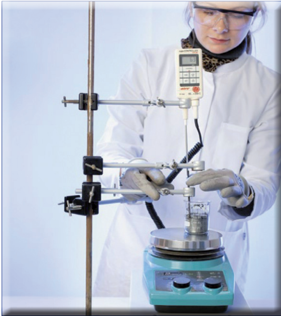
Abbildung 5: Nachdem Schwefel und Graphit miteinander verrührt wurden, wird der Graphitstab in das Becherglas gesenkt, der später zum Abgreifen des Potenzialunterschiedes zwischen der positiven und der negativen Elektrode dient.
