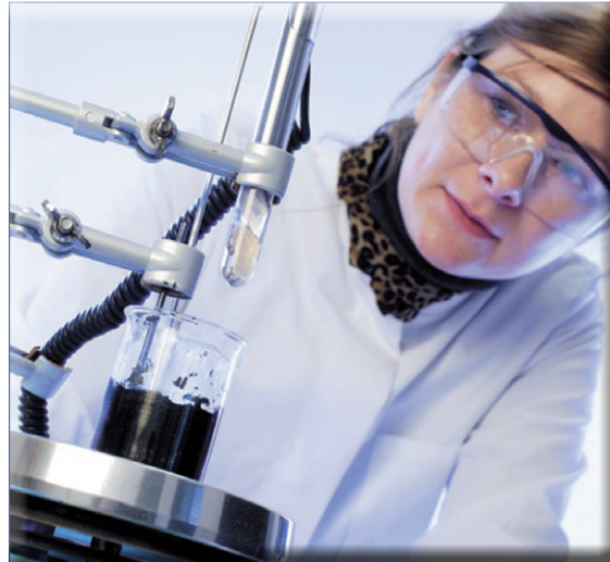
Abbildung 7: Letzte Kontrolle vor dem großen Moment: Photon-Laborantin Janine Karlein begutachtet die Bestandteile des selbstgebauten Natrium-Schwefel-Akkus. Sobald die mit Natrium gefüllte Anode im Reagenzglas in die Kathode (Schwefel-Graphit-Gemisch im Becherglas) gesenkt wird, beginnt die elektrochemische Reaktion.
