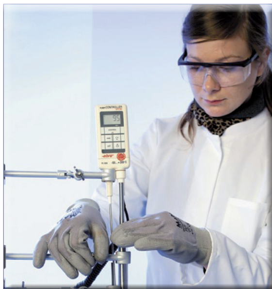
Abbildung 8: Im nächsten Schritt wird das präparierte Reagenzglas langsam in das Becherglas mit der erhitzten Schwefel-Graphit-Mischung gesenkt. Dabei sind Handschuhe und Schutzbrille unverzichtbar, da es zu einer heftigen Reaktion kommen kann, falls das Reagenzglas zerbricht und das Natrium mit dem Schwefelgemisch ungehindert reagiert. Nach kurzer Zeit ist das Natrium geschmolzen und benetzt das ionenleitende Reagenzglas. Der Eisenstab sorgt dafür, dass die Oberfläche, die das Natrium benetzt, möglichst groß ist, während es gleichzeitig nur ein kleines Volumen einnimmt.
