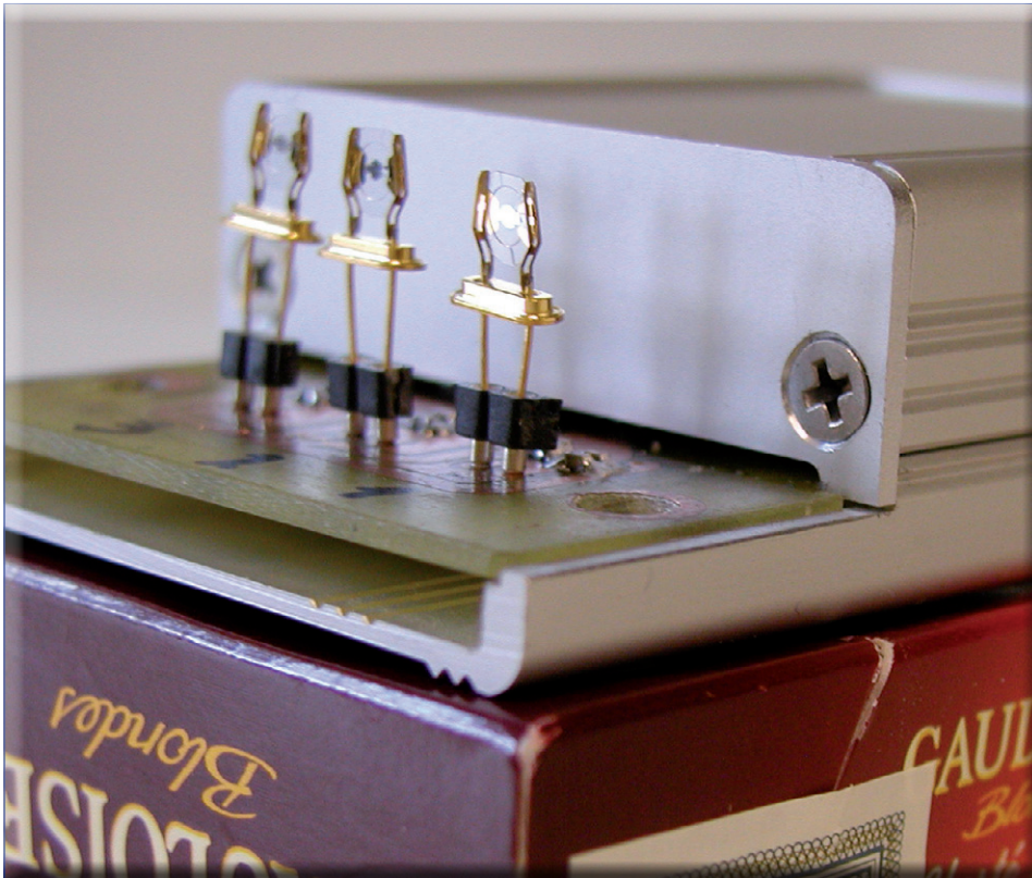
Abbildung 2: Prototyp einer elektronischen Nase, die sowohl Sprengstoffe wie auch Drogen erschnüffeln kann. Drei Quarzmikrowaagen samt der dazugehörigen Elektronik sind kaum so groß wie eine Zigarettenschachtel. Die Materialkosten des Geräts betragen weniger als 1000 Euro. Laut Entwickler Siegfried Waldvogel lassen sich damit noch wenige Milliardstel Milligramm TATP nachweisen (Foto: Uni Bonn/Waldvogel).
