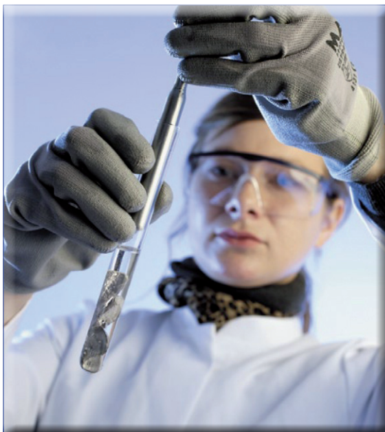
Abbildung 6: Um die Anode zu bauen, gibt man kleine Stücke Natrium in das Reagenzglas und benetzt diese vollständig mit Paraffinöl. Dann wird der Eisenstab vorsichtig in das Glas geschoben.
