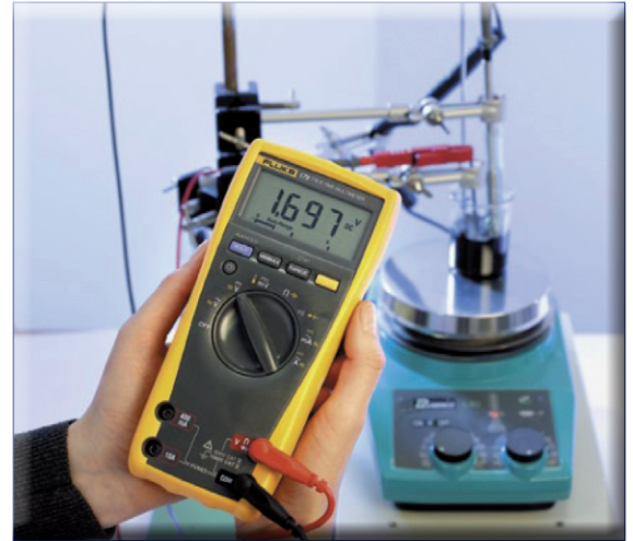
Abbildung 10: Der Blick auf das Messgerät beweist: Die selbst gebaute NaS-Batterie produziert eine Spannung von 1,697 Volt. Diese lässt sich auf über zwei Volt erhöhen, wenn der Graphitstab der Kathode und die Anodenelektrode enger beieinander platziert werden.
