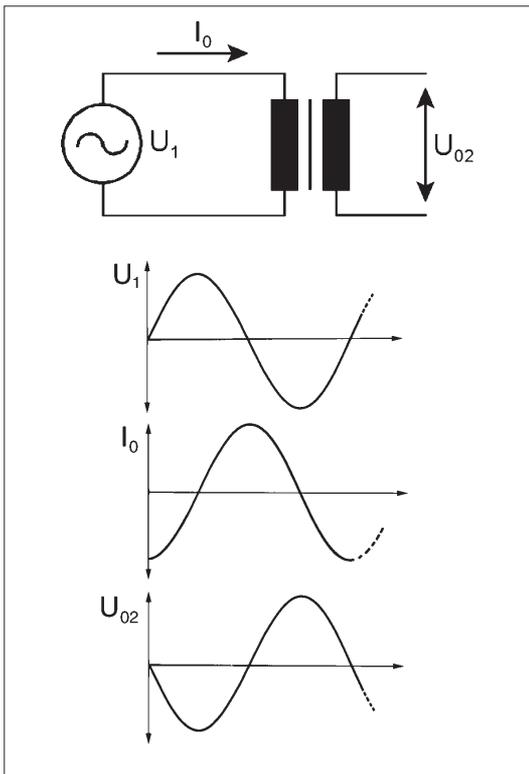
Abb. 3.75: Der Transformator im Leerlauf.
