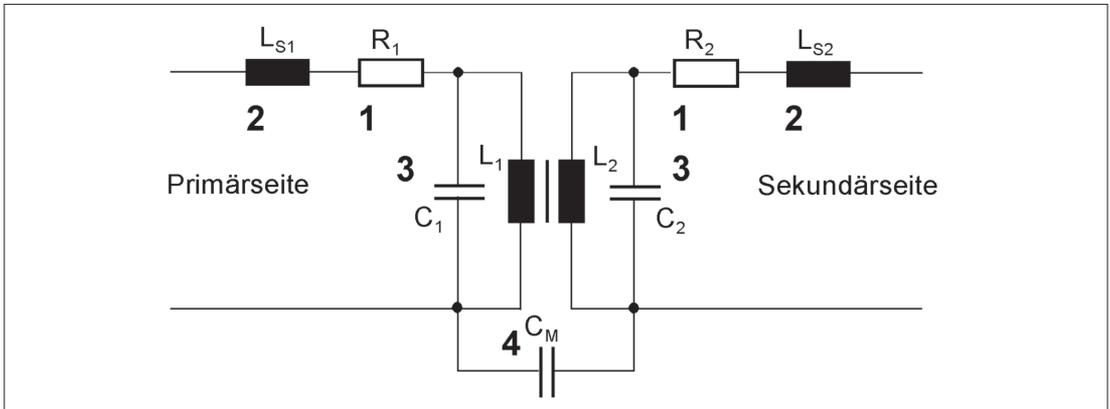
**Abb. 3.80:** Der reale Transformator in einem naiven Ersatzschaltbild. 1 - Wicklungswiderstände; 2 - Streuinduktivitäten; 3 - Streukapazitäten; 4 - Koppelkapazität.
