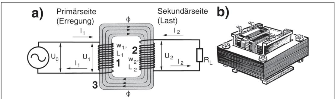
Abb. 3.74: Der Transformator. a) grundsätzlicher Aufbau, b) Ausführungsbeispiel. 1 – Primärwicklung mit Windungszahl  $w_1$  und Induktivität  $L_1$ ; 2 – Sekundärwicklung mit Windungszahl  $w_2$  und Induktivität  $L_2$ ; 3 – Kern;  $\Phi$  – magnetischer Fluss.
