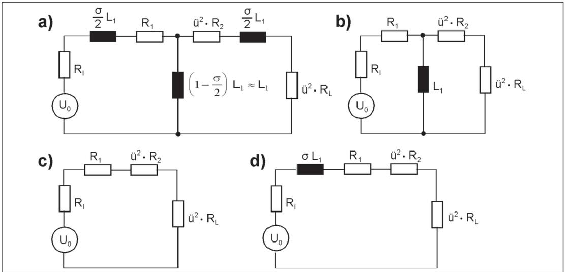
**Abb. 3.82:** Vereinfachte Ersatzschaltungen. a) Vollständig; b) für niedrige Frequenzen; c) für mittlere Frequenzen; d) für höhere Frequenzen. Zu den Bezeichnungen s. Abb. 3.81. Die Streuinduktivitäten ergeben sich hier über den Streugrad  $\sigma$ .
