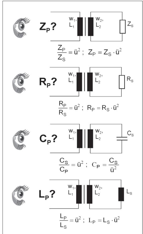
Abb. 3.77: Wie erscheint die Last im Sekundärkreis an den Anschlüssen der Primärwicklung?
