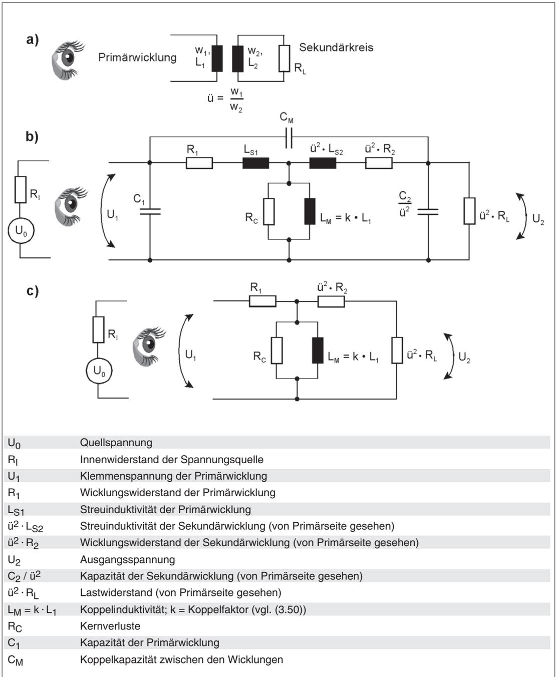
**Abb. 3.81:** Ersatzschaltungen eines Transformators. a) der ideale Transformator; b) eine universelle Ersatzschaltung; c) Vereinfachung für niedrige Frequenzen.
