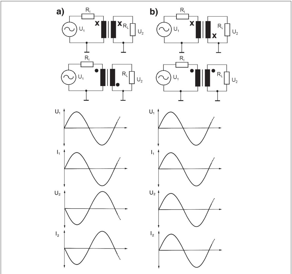
**Abb. 3.79:** Phasenlage und Wicklungssinn. a) gleicher Wicklungssinn (gemäß Abb. 3.78) ergibt eine Phasenverschiebung von  $180^\circ$  (Phasenumkehr). b) entgegengesetzter Wicklungssinn. Keine Phasenverschiebung.
