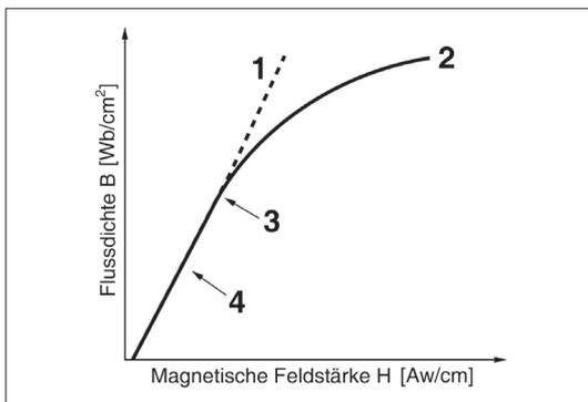
**Abb. 3.83:** Zur Ausnutzung der Magnetisierungskennlinie. 1 - idealer, 2- realer Verlauf. 3 - bis hierher darf die Kennlinie höchstens ausgenutzt werden, darüber hinaus gelangt der Kern allmählich in die Sättigung. Anwendungsbeispiel: Netztransformator. 4 - wenn es darauf ankommt, Strom- und Spannungsverläufe unverfälscht zu übertragen, sollte man den Kern nicht bis zum letzten ausnutzen (Anwendungsbeispiel: Audio-Transformator).
