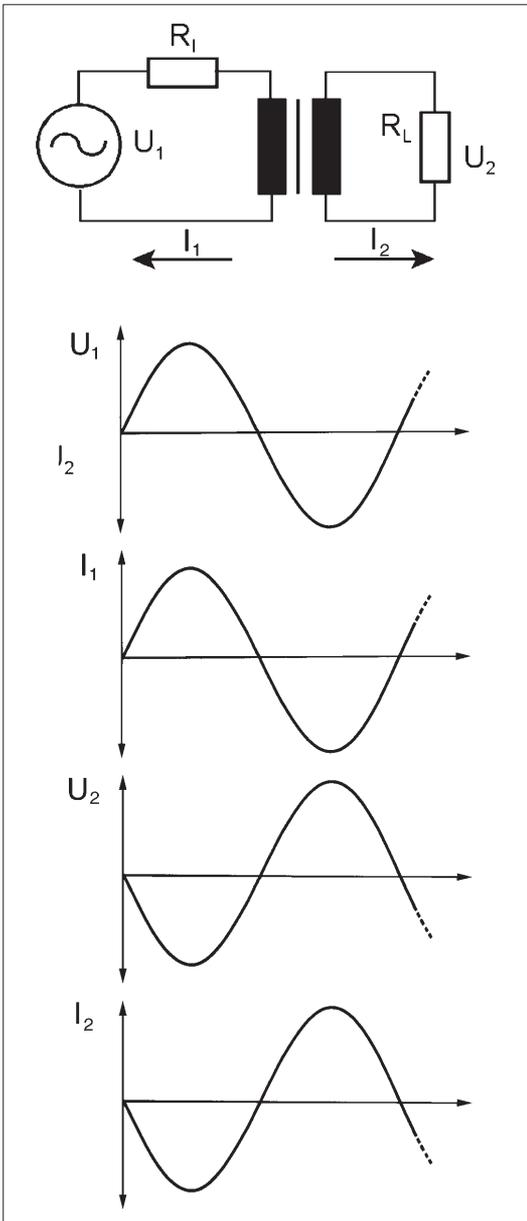
Abb. 3.76: Der belastete Transformator.  $R_i$  = Innenwiderstand der Spannungsquelle,  $R_L$  = Lastwiderstand.
