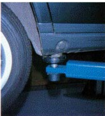
Bild 5 Hier ist das Lastaufnahmemittel an dem vom Fahrzeughersteller vorgesehenen Aufnahmepunkt angesetzt.
