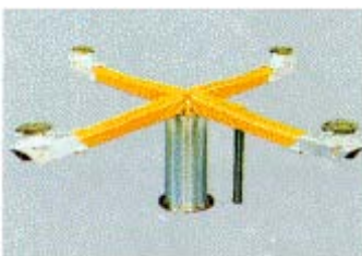
Bild 2 Formschlüssige Verbindung des Schiebestücks mit dem Tragarm.
