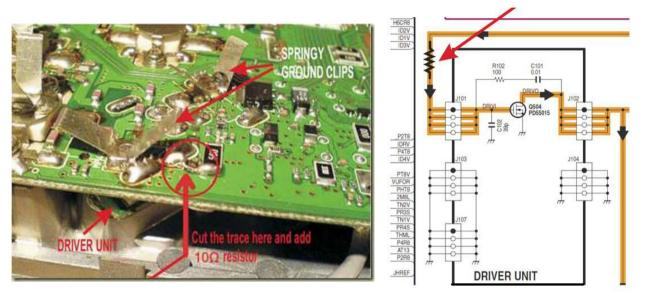
Leiterbahn unterbrechen und 10 Ohm SMD Widerstand einfügen.
