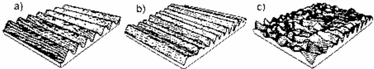
Abb. 1-5: Darstellung der verschiedenen Vereinfachungen des Seegangs. a) regelmäßiger Seegang, b) langkämmiger unregelmäßiger Seegang, c) kurz-kämmiger unregelmäßiger Seegang [CERC, 1984]
