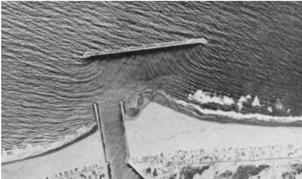
Abb. 2-30: Diffraktion am „Channel Island Harbor“-Wellenbrecher in Kalifornien [CERC, 1984]
