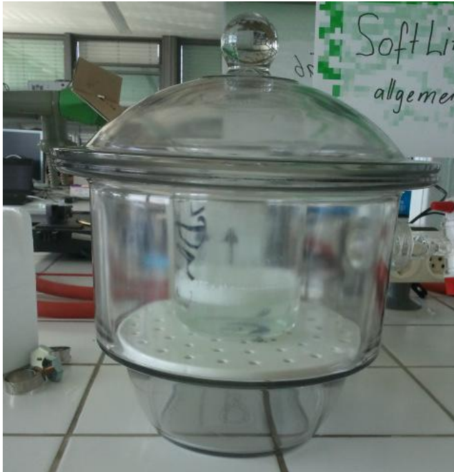
Abb.2: Exsikkator mit PDMS am entgasen
