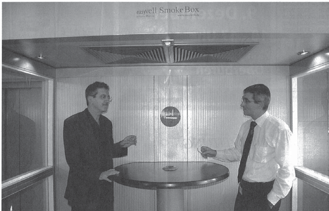
Eine der Raucherkabinen bei Bühler. Sobald ein Raucher den Raum betritt, schaltet sich die Luftabsaugung in der Decke der «Smoke Box» ein und zieht den Tabakqualm grossflächig an. Bild: zvg.
