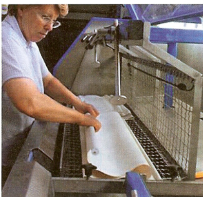
Maschinelle Reinigung eines Rollos im hubmechanischen Bad unter Zusatz von Reinigungsmitteln.
