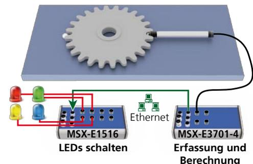
Applikation: Ergänzung eines optischen Wellenmessgeräts mit einer taktilen Messeinrichtung
