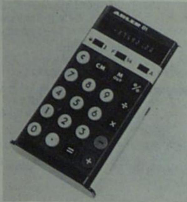
Vier Rechenarten, 8stellige Kapazität, Fließkomma und Fließ/Festkomma mit  $\frac{5}{4}$ -Rundung, automatische Konstante, Prozentautomatik, ein Speicher, Wiederholungsrechnung, universelle Stromversorgung: Trockenbatterien, wiederaufladbare Akkus (Mehrpreis DM 40,20) oder Netzbetrieb über Adapter.
