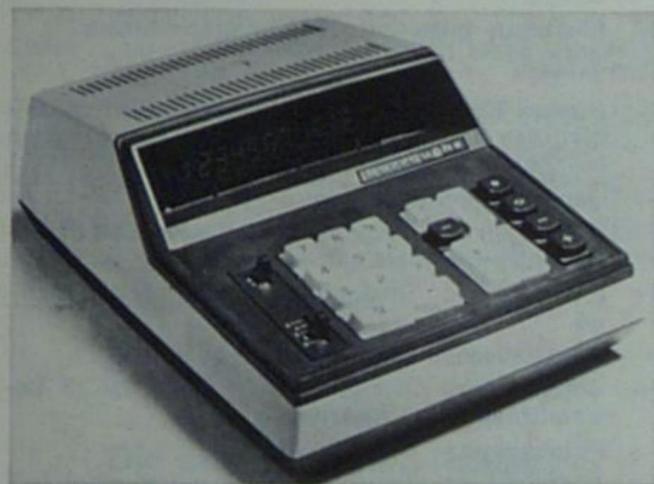
Anzeigender elektronischer Tischrechner für vier Grundrechenarten, ein saldierender Speicher mit +, —, <>, \* Tasten, steckbare LSI-Bausteine, rote 10stellige Burroughs „PANAPLEX“-Anzeige — blendfrei, Vornullenunterdrückung, Minus- und Speicherbelegungsanzeige, Überlaufanzeige.
