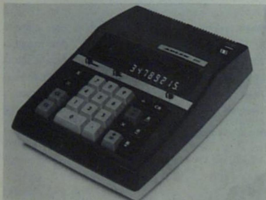
Vier Rechenarten, 8stellige Kapazität, Fließ-/Festkomma, 5/4- und 1/0-Rundung, Prozentautomatik, ein unabhängiges Speicherregister mit Belegt-Anzeige, Konstante für vier Rechenarten, grüne Digitronanzeige.
