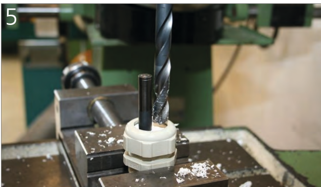
5 Bei Anfertigung eines zweiten Bohrloches ist das erste mit einem Bohrer oder mit einem passenden Bolzen zu verschließen, um dem Dichteinsatz eine Formstabilität zu geben. Mindestwandabstände zwischen den Bohrungen: 1 mm Bei Bohrungsdurchmesser >10 mm = 2 mm When making a second bore-hole, the first has to be closed with a drill or fitting bolt to give the sealing insert dimensional stability. Minimum wall thickness between drillholes of 1 mm With a drilling diameter >10 mm = 2 mm
