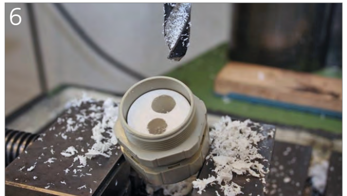
6 Zweite Bohrung in der Ansicht von unten Second bore-hole seen from below
