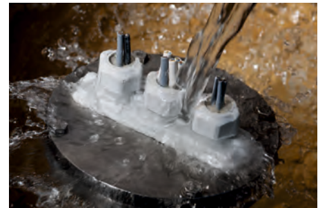
Abb. 2 – Der UNI FLANSCH bei der Wasserschutzprüfung Fig. 2 – UNI Flange® in a water ingress test
