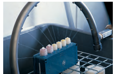
Abb. 1 – PFLITSCH-Kabelverschraubungen IP 54 Fig. 1 – PFLITSCH cable gland IP 54
