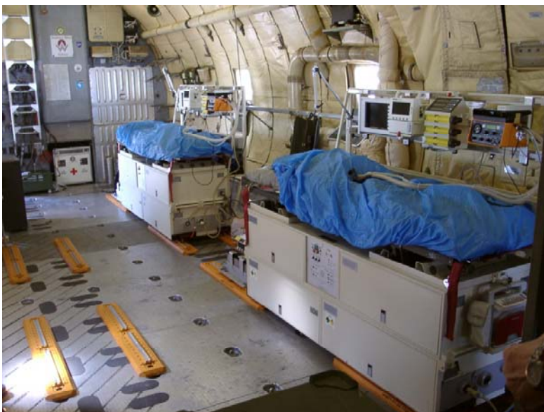
Abb. 21.2: PTE eingerüstet in eine C-160 „Transall“
