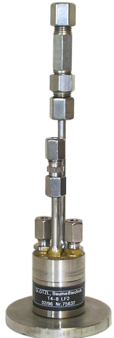
Abb.: Setzungsmesser Typ: TB 4/8 LF 20
