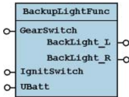
Abbildung 3: Software-Komponente mit Signalschnittstellen (Beispiel: Rücklichtsteuerung) / software component with signal interfaces (example: back light control)
