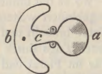
a. die Kugel von Ebenholz, b. der Bügel von Nickel, c. ein Schraubchen.
