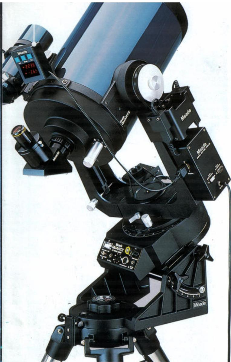
Meade DSC an einem 2080/LX5 Schmidt-Cassegrain: (1)=Encoder für Deklination (2)='Junction Box' für die Elektronik und den Mikroprozessor (3)=Encoder für Rektaszension (4)=Display Einheit.
