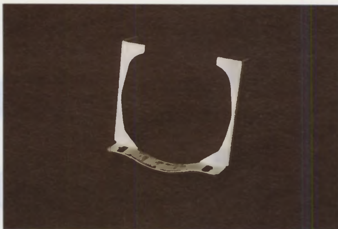
Bild 2 : Das Lüfterbefestigungsblech nach der Bearbeitung
