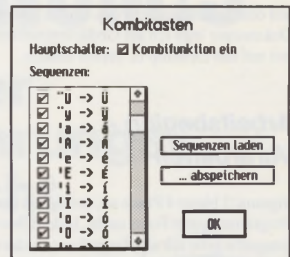
Bild 5: Übersicht über die Kombitasten. Durch Nacheinanderdrücken von 2 Tasten wird die entsprechende Ligatur anstatt 2er-Zeichen ausgegeben.
