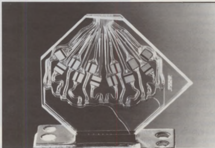
Der 24-Düsen-Druckkopf des EPSON ist aus Glas. Deutlich zu erkennen: die Piezo-Elemente.
