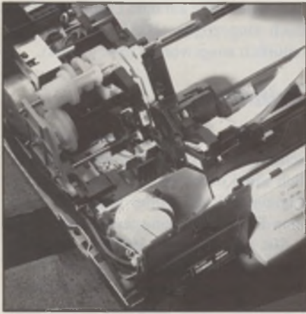
Im Innern des BJ-300: Druckkopf mit Bürste und Verschließmechanismus
