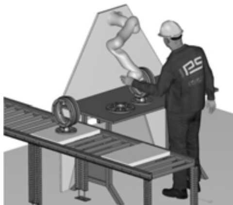
Abb. 2: Grafische Darstellung des manuellen Führens eines Leichtbauroboters
