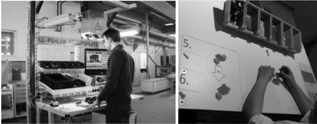
Abb. 2: Beispiele für ein Montageassistenzsystem (links, Quelle: DE software & control) und In-Situ-Projektion (rechts, Quelle: [4])
