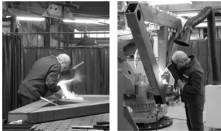
Abb. 1: Schweißen der gleichen Naht ohne und mit robotergestütztem Assistenzsystem
