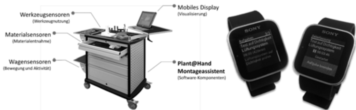
Abb. 4: Plant@Hand Montageassistenzsystem in einem Werkstattwagen (links) und mobile Anwendung auf einer Sony Smartwatch (rechts, siehe auch [10])
