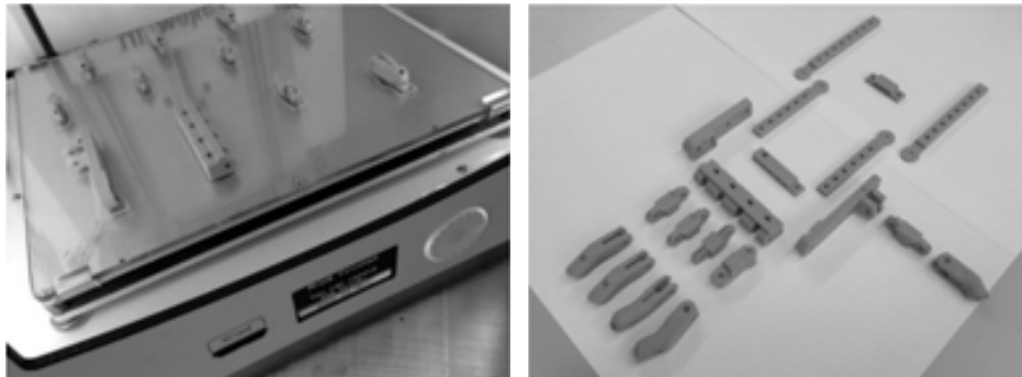
Abb. 4: Fingerglieder der Robohand im 3D-Drucker (links) und Übersicht aller 3D-gedruckten Bauteile der originalen Robohand (rechts)
