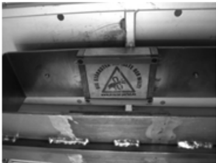
Abb. 3: Permanentmagnet an der Trittplatte
