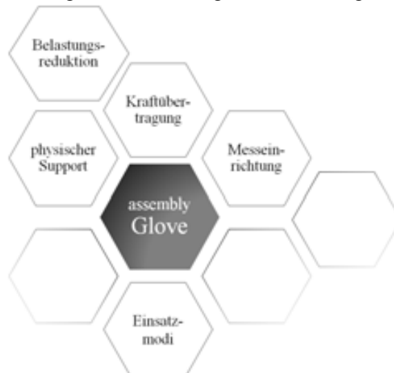
Abb. 7: Funktionen eines Montagehandschuhs
