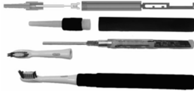
Abb. 2: Ansicht der Zahnbürste und des innenliegenden Funktionsträgers.
