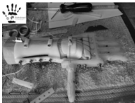
Abb. 1: Seilzugbetriebene Handprothese des Projekts „Robohand“ (Bildquelle: Richard van As / Robohand [4])
