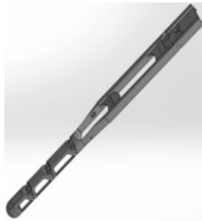
Abb. 2: CAD Modell des FGL-Fingers
