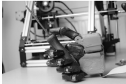
Abb. 2: Mechatronische Handprothese „Dextrus“ (Bildquelle: Joel Gibbard / The Open Hand Project [5])
