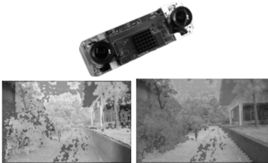
Abb. 7: Oben: Autonomos-Kamera. Unten links: 3D Karte. Unten rechts: Bodenextraktion.
