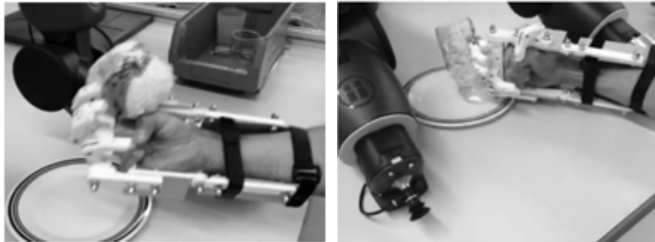
Abb. 8: Greifen der repräsentativen Alltagsgegenstände (links: Verpackungsmittel, rechts: Glaskrug) mit den zwei unterschiedlichen Greifmustern
