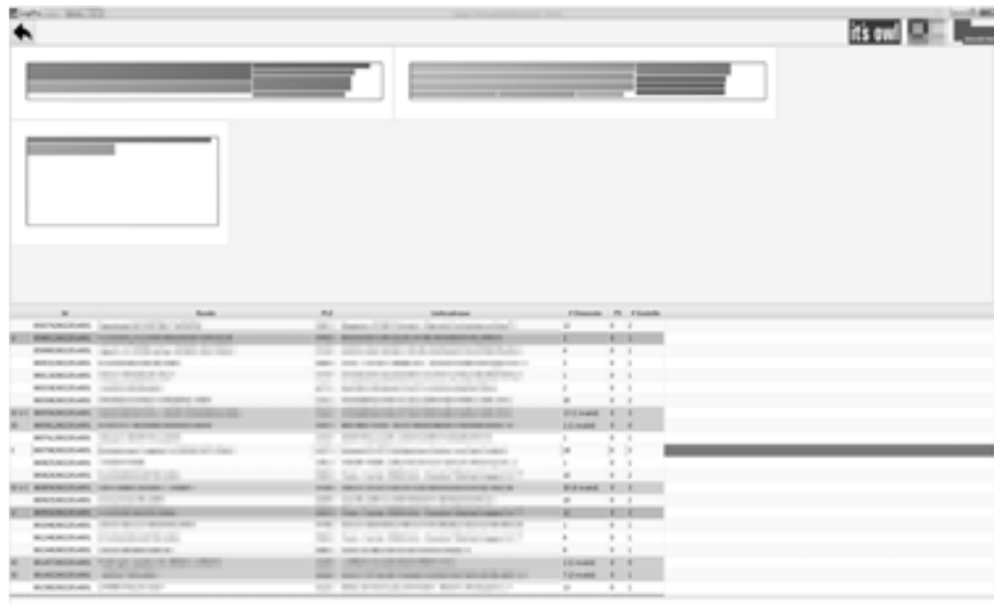
Abb. 2: Explorationsansicht des ersten Prototyps. Bestellungen (unten) werden anhand von benutzerdefinierten Regeln hervorgehoben. Für eine ausgewählte Bestellung wird ein Beladungsvorschlag generiert und wahlweise in 2D oder 3D angezeigt (oben).
