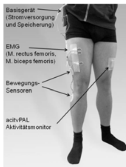
Abb. 1: Prototyp der Messtechnik ohne Orthese, Sensorik aufgeklebt
