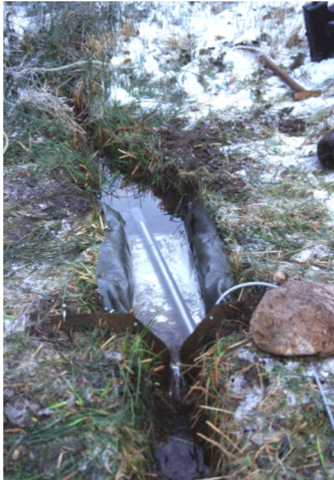
Abb. B5: Foto des eingebauten Messwehres mit Multisonde
