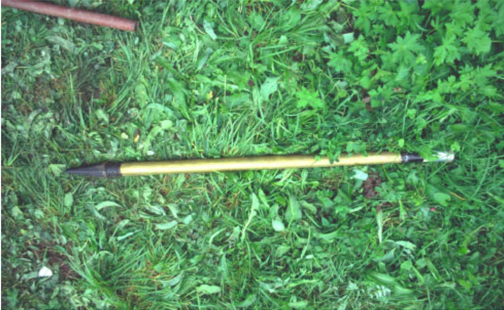
Abb. 3.2: Filterrohr mit Rammspitze einer Grundwasserbeobachtungsstelle
