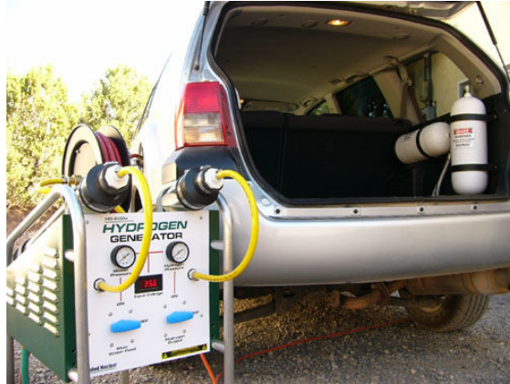
Abb. 59: Mitsubishi Endeavour ausgerüstet mit zusätzlichen CGH2 Tanks mit dem Elektrolyseur zur Betankung [www.switch2hydrogen.com/h2.htm]
