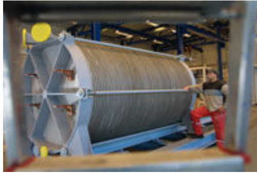
Abb. 18: Norsk Hydro Elektrolyseur; ca 485 Nm 3 /h ~ 2MWe; Platzbedarf 4x13m 2
