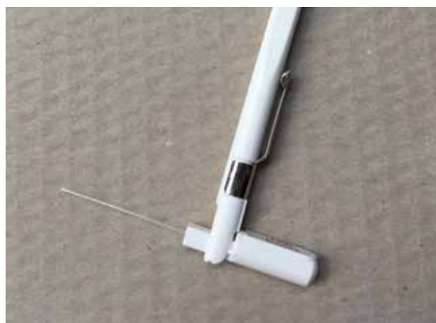
Abb. 1: VON-FREY-FILAMENT ZUR MESSUNG DER BERÜHRUNGSEMPFINDLICHKEIT.
