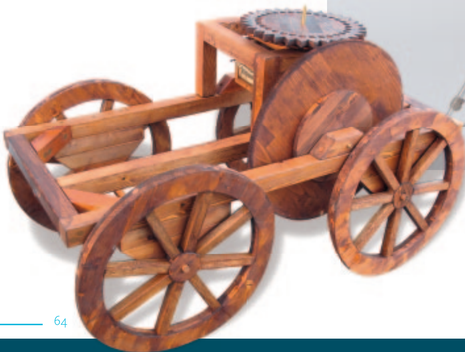
46 Nachbau eines römischen Messwagens (Hodometer) zur Streckenvermessung. Holz, 150 x 110 cm, Privatsammlung Florenz
