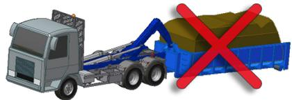
Heben Sie keine Lasten an, welche die Spezifikationen des Hakenlifts überschreiten.
