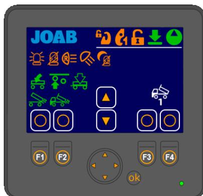
Welche Funktionssymbole (F1–F4 und die Pfeiltasten AUF/AB) in der Benutzeroberfläche angezeigt werden, hängt davon ab, welche Seiteneinstellung ausgewählt wurde. Es gibt fünf verschiedene Seiteneinstellungen. Um zwischen diesen zu wechseln, drücken Sie entweder die linke oder rechte Pfeiltaste unterhalb des Bildschirms. Weitere Informationen finden Sie unter *"Seiteneinstellungen"*, auf Seite 14.
