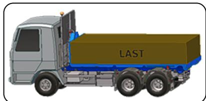
Wenn sich loses Material am Aufbau befindet, muss dieser abgedeckt werden. Wird er nicht abgedeckt, besteht die Gefahr, dass das lose Material vom Fahrzeug herunterfällt.
