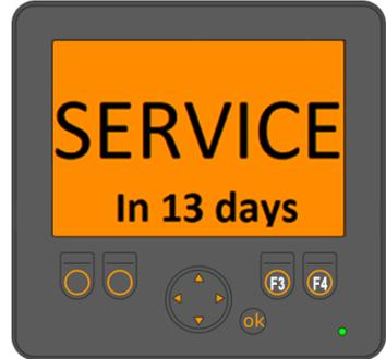
Um die Servicewarnung zu beenden, drücken Sie einfach die OK-Taste am unteren Rand des Displays. Die Servicewarnung wird von JOAB während der Instandhaltung zurückgesetzt.
