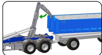
14. Achten Sie darauf, dass die Kippzylinder vollständig eingefahren sind und fahren Sie dann das Verlängerungsstück so aus, dass der Aufbau vollständig auf dem Hakenlift aufgeladen ist.
