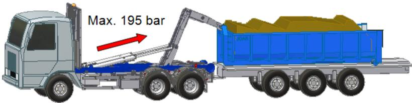
Wenn die Kraft auf die Kippzylinder zunimmt, wird das Fahrzeug angehoben. Es ist nicht möglich, dies einzuschränken. Der Anhänger hingegen wirkt dieser Kraft entgegen, da er mit dem Fahrzeug verbunden ist. Wenn die Kraft auf die Kippzylinder auf über 195 bar erhöht wird, führt dies zu Schäden.
