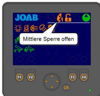
8. Aktivieren Sie die Kippfunktion, sodass der Hakenlift in der Position ist, in welcher der Aufbau wie dargestellt aufgenommen werden kann.
