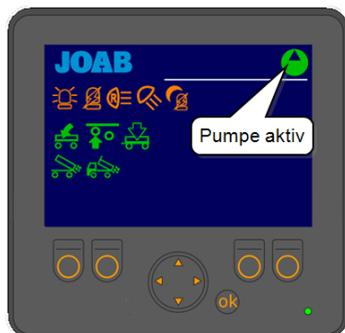
5. Öffnen Sie die hydraulische Sperre. Nach dem Öffnen wird in der CBW-Steuerung das Symbol für die geöffnete hydraulische Sperre angezeigt.
