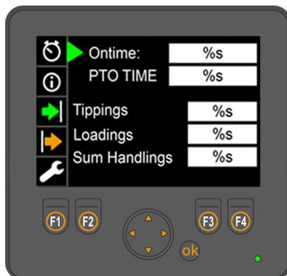
Verwenden Sie die Pfeiltasten, um durch das Menü zu navigieren. Mit den Pfeiltasten nach oben und unten können Sie durch das Menü navigieren. Die Pfeiltasten nach links und rechts ermöglichen es dem Benutzer, bei Bedarf aus Optionen auszuwählen.
