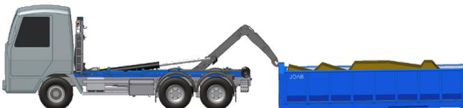
8. Betätigen Sie das Verlängerungsstück und stellen Sie sicher, dass sich der Haken des Hakenlifts frei von der Hebevorrichtung des Aufbaus bewegt.
