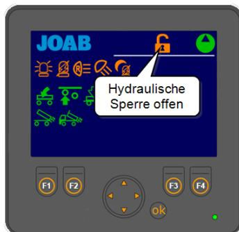
5. Fahren Sie das Verlängerungsstück vollständig ein und bewegen Sie den Aufbau wie dargestellt nach außen. Die mittlere Sperre öffnet sich.
