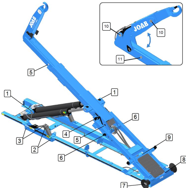
Die Wartung der Schmierstellen am Hakenlift sollte in der Regel dem Wartungsplan des Fahrzeugs für die Schmierung folgen. Die Schmierstellen des Hakenlifts müssen jedoch immer alle 75 Betriebsstunden gewartet werden.
