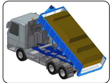
8. Senken Sie den Aufbau nach dem Kippen wieder in seine eingefahrene Position ab.
