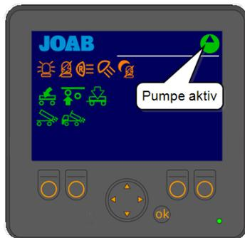
4. Öffnen Sie die hydraulische Sperre. Nach dem Öffnen wird in der CBW-Steuerung das Symbol für die geöffnete hydraulische Sperre angezeigt.
