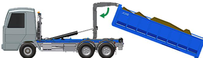
14. Laden Sie den Aufbau auf den Hakenlift und ziehen Sie das Verlängerungsstück vollständig heraus. Um das Beladen zu erleichtern, muss sich das Fahrzeug im Leerlauf befinden und frei unter den Aufbau rollen können.
