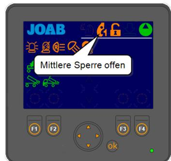
7. Aktivieren Sie die Kippfunktion und lassen Sie den Aufbau frei auf den Boden rollen. Alternativ können Sie das Fahrzeug auch vorwärts rollen lassen.
