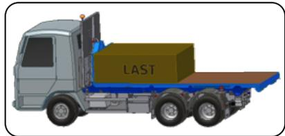
Es ist außerdem wichtig zu berücksichtigen, wie lang der Aufbau ist. Die Länge des Aufbaus und die Last beeinflussen die Tragfähigkeit des Hakenlifts.
