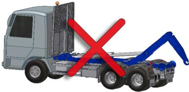
Fahren Sie das Fahrzeug nicht mit ausgefahrenem Hakenlift. Dieser muss vollständig eingefahren sein.
