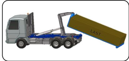
Wenn eine Last ungleichmäßig verteilt ist, kann die Tragfähigkeit reduziert werden. Wenn die Last beispielsweise an der Vorderseite des Fahrzeugs angebracht wird, kann die Tragfähigkeit um bis zu 40 % reduziert werden.
