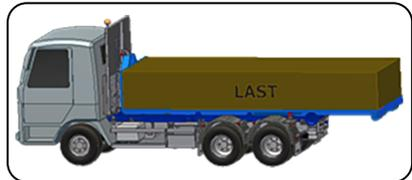
Ein kurzer Überhang verursacht eine ungewöhnliche Belastung. Ein korrekt konstruierter Aufbau für Ihr Fahrgestell verteilt die Last ordnungsgemäß.
