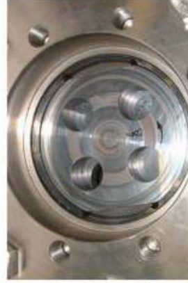
Blick in eine Zellenradschleuse
