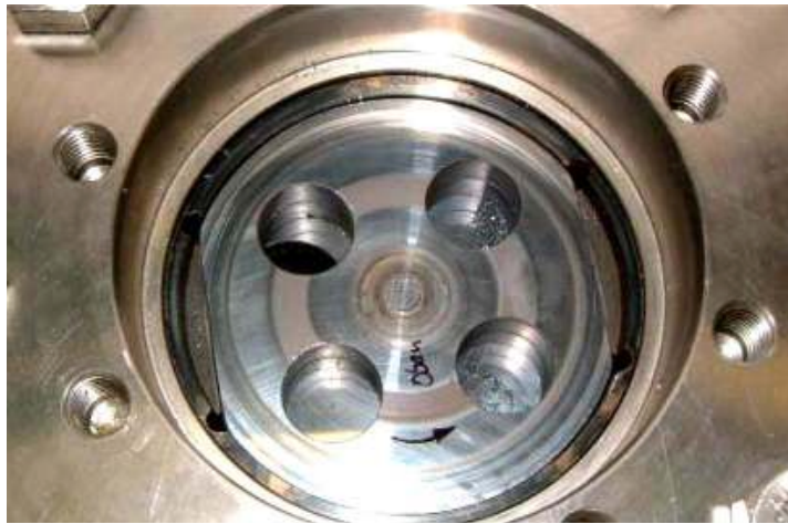
Bild 26: Blick in eine Zellenradschleuse
