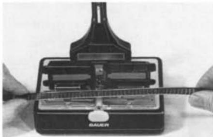
Solo dopo ca. 10–15 secondi d'indurimento (osservare le indicazioni del collante usato), premere il pulsante **6** per aprire il pressore **1**.
