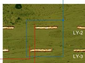
Die Toleranzen beim Registrieren und Stanzen der Innenlagen vor dem Verpressen, bei der Aufnahme der Innenlagen im Preßwerkzeug und das Driften der Lagen während des Verpressens haben einen (...zusätzlichen) Einfluß auf die Toleranz der Impedanz des Leiterbahnpaars.
