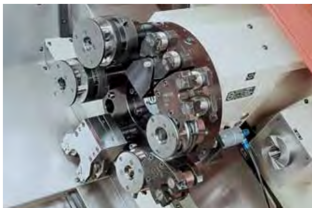
Revolver einer CNC-Drehmaschine, komplett bestückt mit allen Fette-Rollkopftypen (Demonstration)
