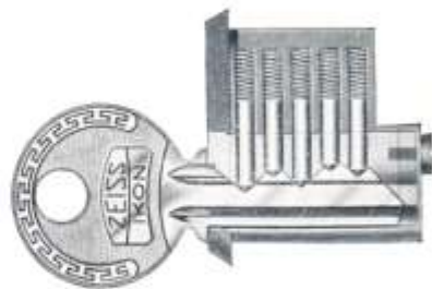
Abb. 1. Querschnitt des Zylinders nach Einführen des richtigen Schlüssels
