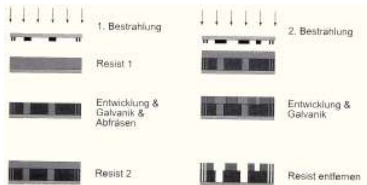
Abbildung 4: 11 Aufwachsen einer zweiten Galvanikschicht durch Wiederholen des LIGA Prozesses
