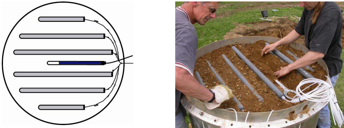
Fig. 2. Schematischer Aufbau und Foto des Matrixpotentialrechen/sketch and foto of suction cup rake
