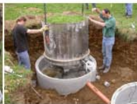
Einbau des Lysimeters auf die Wiegezellen
