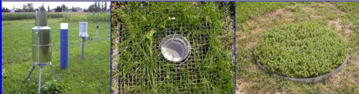
Niederschlagswaage, Totalisator, Niederschlagswippe Bodenebene Niederschlagswippe Wägbares Präzisionslysimeter
