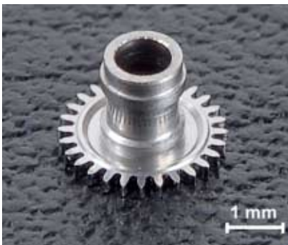
BILD 5. Gedrehtes Uhrzahnrad: Mittels MBS wird die Bohrung nachgearbeitet
