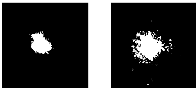
Bild 7 + 8: Die monochromatisierten Aufnahmen des Laserstrahles, links Abstand 40cm und rechts mit 160cm. Quelle: Eigene Zeichnungen.
