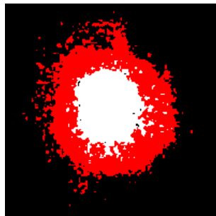
Bild 12: Die Aufnahmen des Laserstrahles mit rot Abstand 40cm und mit schwarz 160cm. Quelle: Eigene Zeichnungen.
