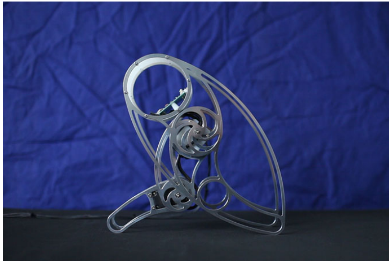
Abbildung 8.2: SEMNI: Ein Roboter für die Erprobung unüberwachter Lernverfahren zur Selbstexploration.
