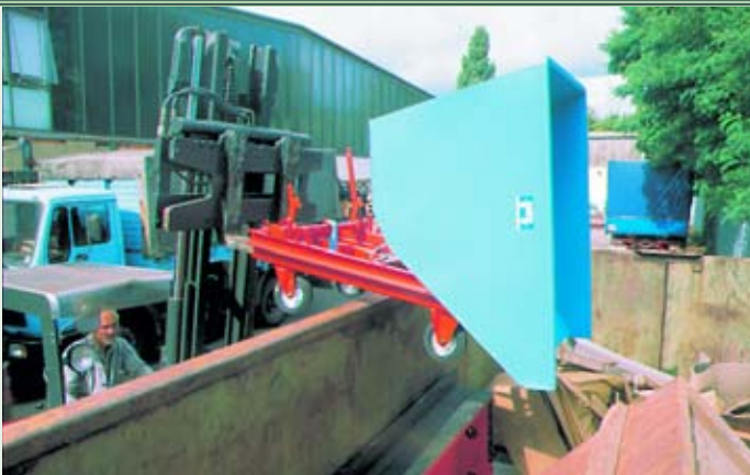
Zum Ausschütten: Der Selbstkipper wird über eine feste Kante ausgelöst.
