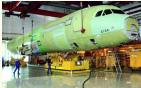
Luftikus mit Nehmerqualitäten: Das Luftkissen-Transportsystem von Solving mit einem seiner „Babies“.
