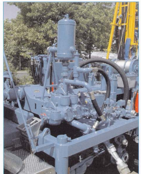
Duplex-Kolbenpumpe mit hydr. Antrieb, Windkessel und Sicherheitsventil zum Abteufen der Bohrungen und zur Injektion der Erd-Wärmesonden für Bohrtiefen bis ca. 300 Meter.
