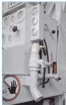
Anschlussleitung für Beistellkompressor mit Kontroll-Manometer für Bohrbetrieb und Steuerleitung für den Doppelrotorkopf.
