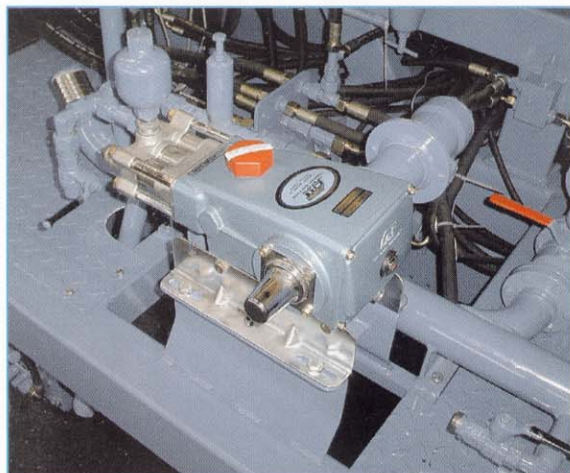
Triplex-Kolbenpumpe mit Mengenregelung zur Wassereinspeisung in die Kompressorleitung. Die Befeuchtung ermöglicht ein staubfreies und sicheres Austragen des Bohrgutes.
