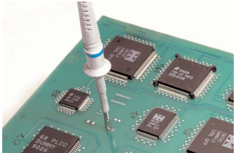
Freihändiges Messen mit dem PCB Adapter
