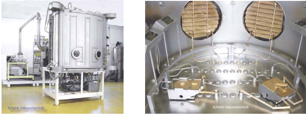
Abb.3.6: Vakuum-Rezipient (Schenk Vakuumentech) - Die Anlage wird zur Erzeugung von Dünnschichten in der Halbleiterfertigung eingesetzt und verfügt über zwei Pumpstände für ununterbrochenen Betrieb und damit maximale Produktivität.
