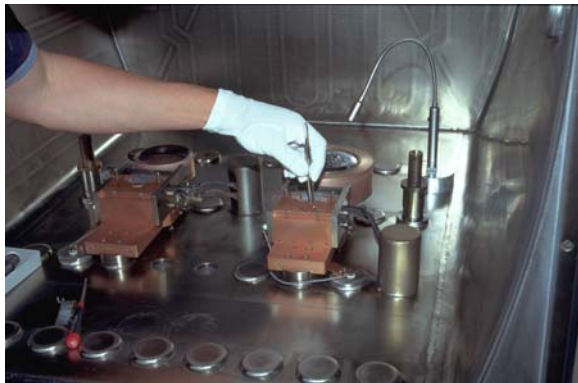
Fig. 16: Wartung der Elektronenkanone [10]
