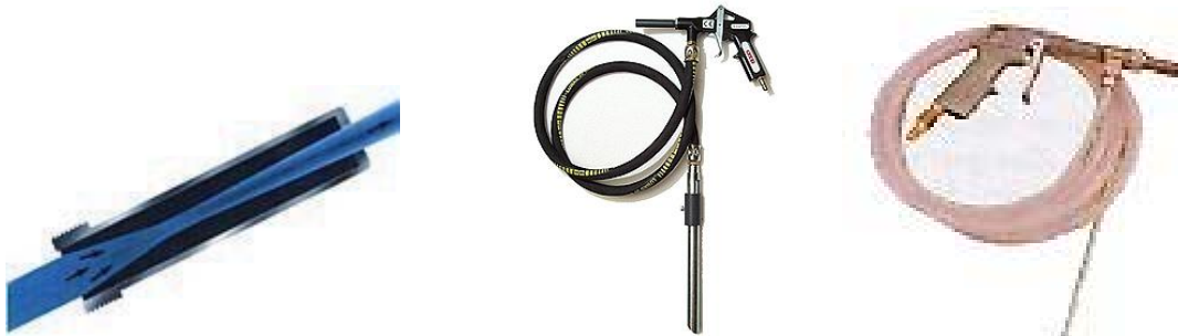
Abb.12: Venturi-Strahldüse: Durch die strömungsgünstige Form des Blaskanals ist die Austrittsgeschwindigkeit des Strahlmittel-Luftgemisches ungefähr doppelt so hoch als bei der zylindrischen Ausführung Strahlpistolen: Einsetzbar im Druckbereich von 1-10bar; Strahlmittelmenge kann dosiert werden; Korngrößen von 0,05mm bis 1,4mm; Durchmesser-Strahldüse: 4-6mm; Luftverbrauch: 185 bis 600 l/min
