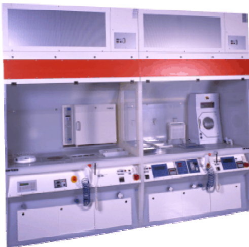
Abb.3: Beispiel für eine laminar flow box Einheit (links) und Reinraumkabine (rechts)
