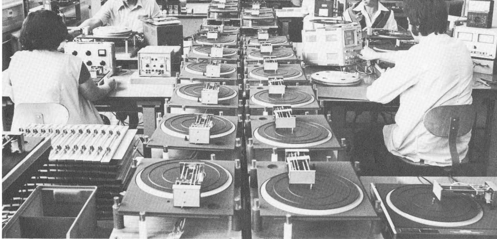
21 Am Ende des Montagefließbandes werden die beiden Teile, Elektronik und Antrieb zusammengebaut und haben anschliessend einen Dauerlauf von min. 24 Std. zu bestehen.
