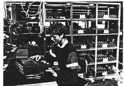
Fertig montierte Geräte werden in den "Dauerlaufwagen" gestellt. Jede dieser installierten und fahrbaren Einheiten fasst 15 Revox-Geräte beliebigen Typs. Das Bild zeigt den Arbeitsplatz "Kleinmischpult" mit Dauerlaufwagen.
