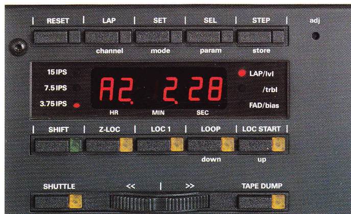
Das Einmesszentrum: multifunktionelles Tastenfeld und Display als Einmessinstrument
