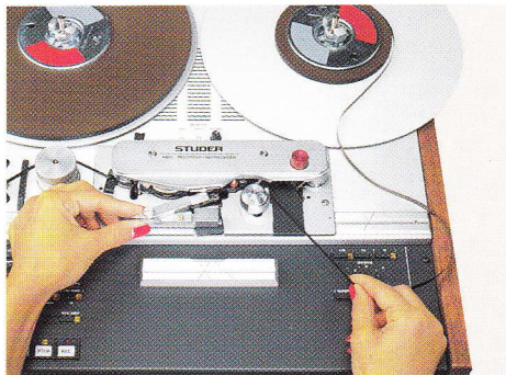
Haargenaues Bandmarkieren bei korrekter Bandführung und das präzise, winkelgetreue Bandschneiden sorgen für einwandfreie Splice-Stellen und machen das Bandschneiden bei der A807 zum Vergnügen.
