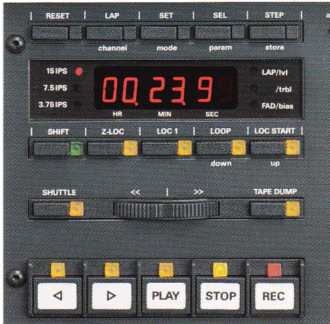
Multifunktional: Das Bandzählwerk und die Laufwerkfunktionen der STUDER A807 Familie.
