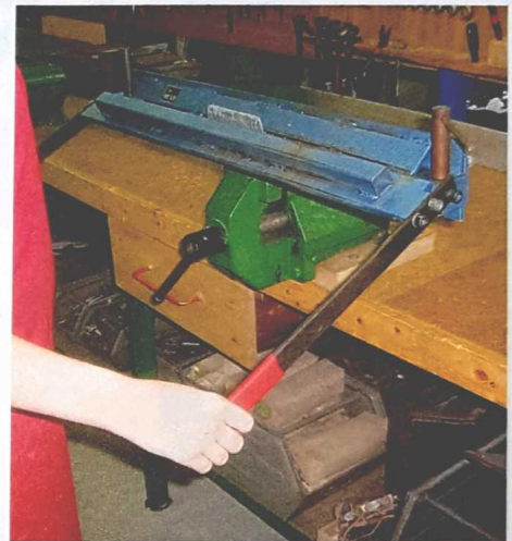
Biegen mit der Abkantvorrichtung
