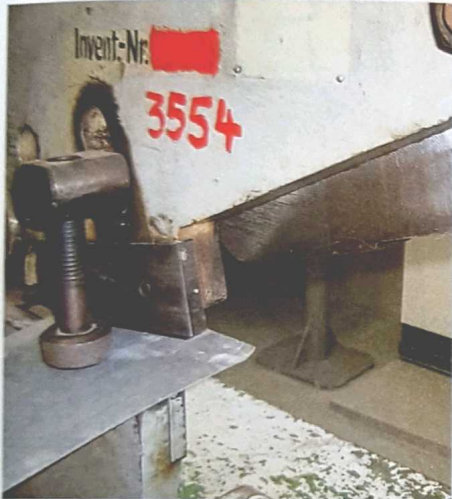
Schneiden mit der Handhebelschere
