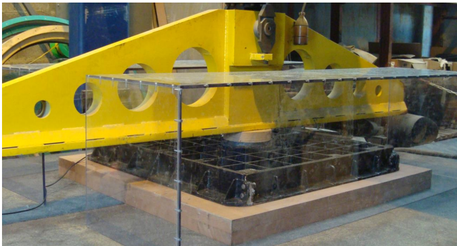
Bild 10 Schachtabdeckung der Firma Nottaris beim Zulassungstest ( www.nottaris.ch )
